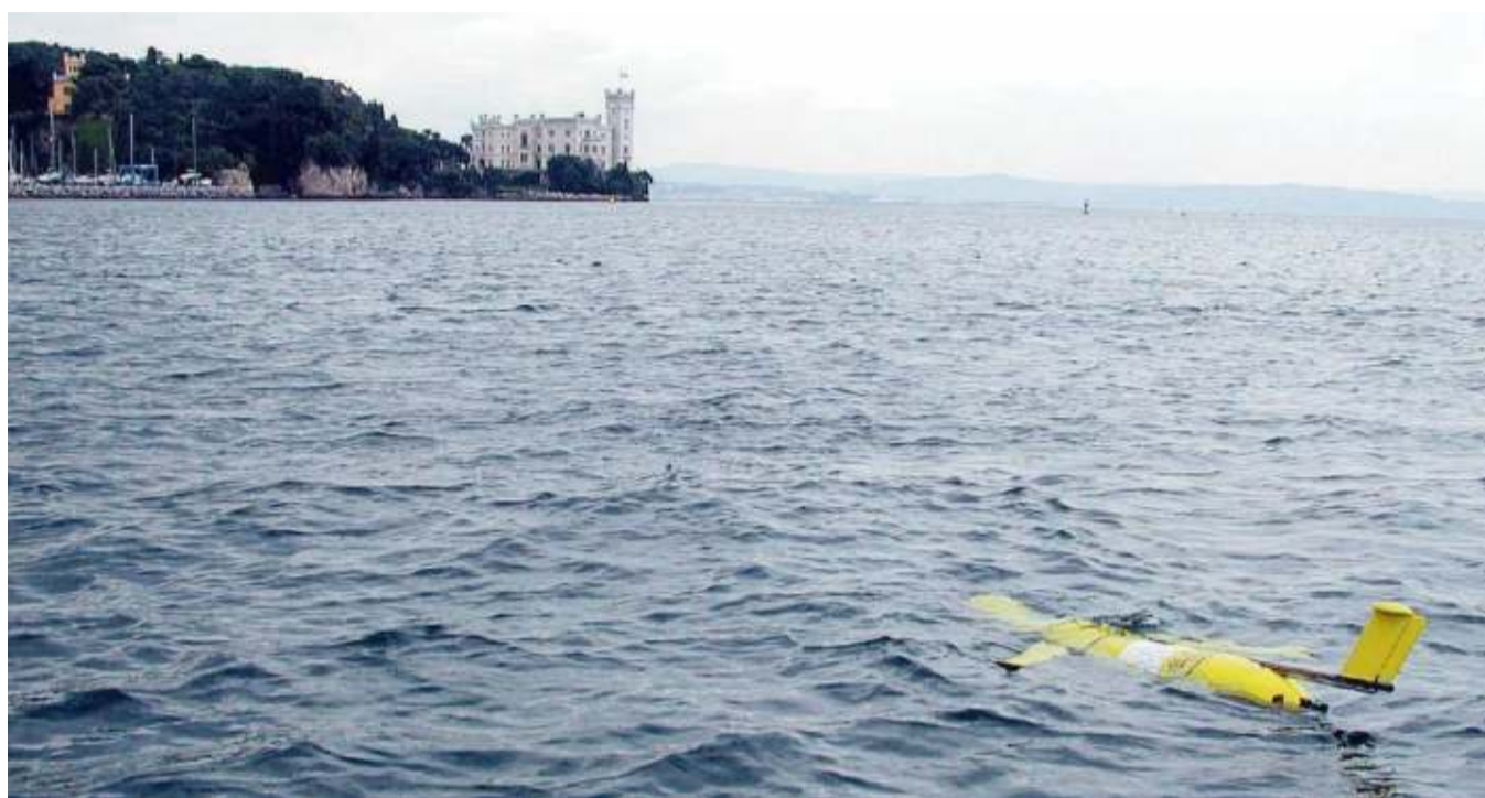
Droni e alianti sottomarini utilizzati dall'Ogs per verificare lo stato di salute del mare
